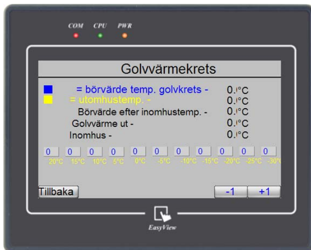
Figur 29. Meny "Temp. kurva golvvärmekrets"
