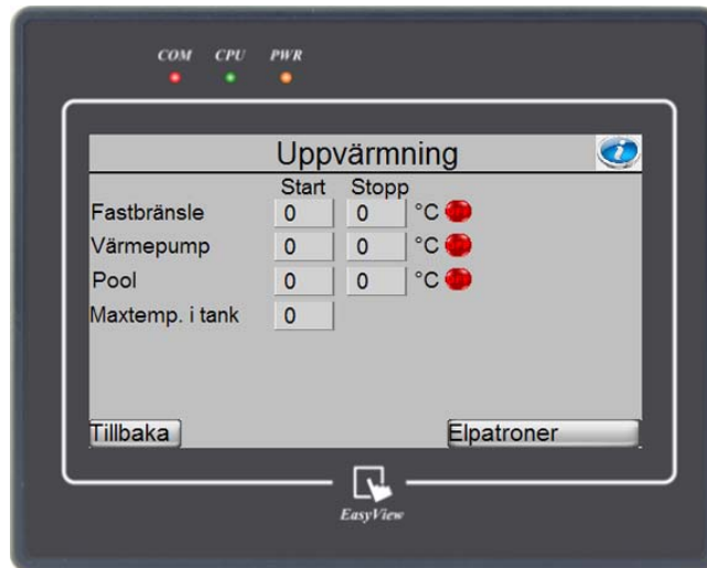
Figur 21. Meny "Uppvärmning systemtank"
