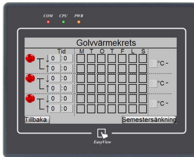
Figur 30. Meny "Schemalagda temperaturändringar golvvärmekrets"
